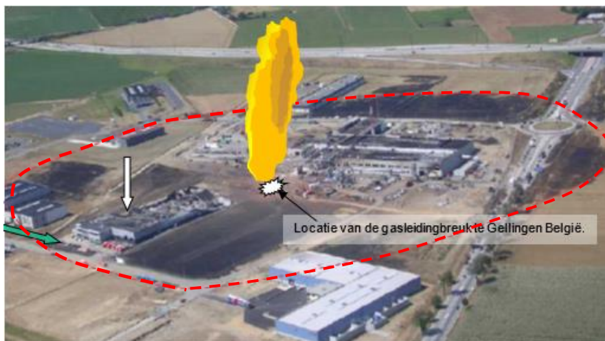
Figuur 4. De risicoschil geprojecteerd over het schadegebied van een fakkelbrand door een leidingbreuk van een hoge druk aardgasleiding. Het ongeluk gebeurde in België te Gellingen door graafwerkzaamheden waarbij de leiding werd geraakt en brak. De rode stippellijn geeft de contour weer van de eerste risicoschil. Binnen deze afstand bieden gebouwen geen bescherming tegen de dodelijke warmtestraling. De fakkel is schematisch in de foto getekend (De hoogte van de fakkel is niet irreëel weergegeven).
