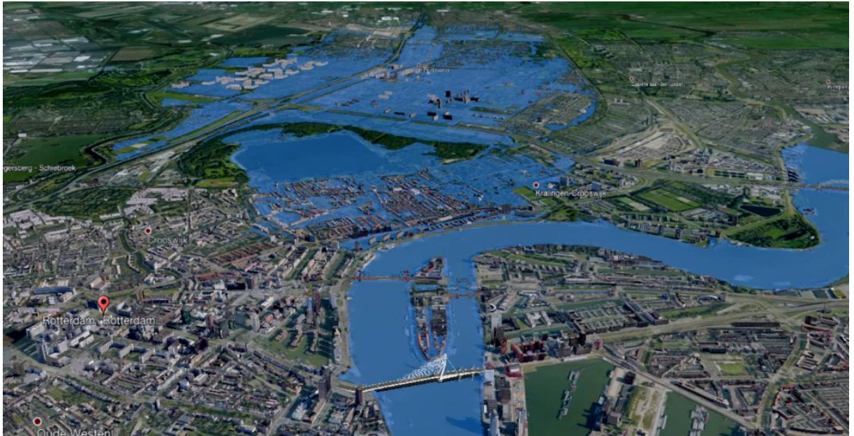
Figuur 4: 3d visualisatie van de overstroming in Rotterdam-Noord na dijkdoorbraak bij het Boerengat en doorbreken van een achterliggende compartimenteringskering. Ook het buitendijkse gebied kent hevige wateroverlast, o.a. op het Noordereiland (bron: Stichting 3Di).
