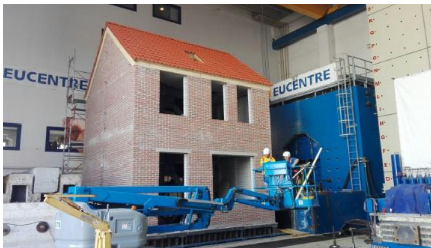
[Red. Medewerkers van Onderzoeksbureau EUCentre in Lombardije (Italië) onderzoeken met een nagebouwd veelvoorkomend rijtjeshuis in Groningen op een trilaafel de bevinsgbestendigheid. TU Delft en TU Eindhoven onderzoeken de sterkte van betsaand mestelwerk uit Groningen.]
