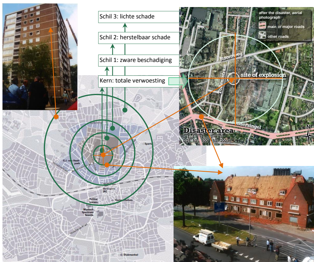
Figuur 2. Schadebeelden in ringen rond de risicobron: een algemene karakteristiek
