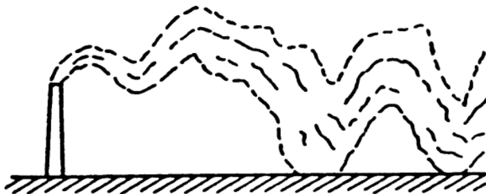
Afbeelding 3.3 Dispersie van een gaswolk in een instabiele omgeving (Ineris, 2005)
