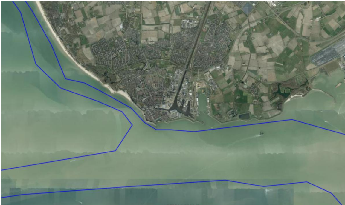
Figuur 7. Referentiepunten op de Westerschelde (ter hoogte van Vlissingen). De Westerschelde is geen binnenwater, maar is open verbonden met de zee. Eb- en vloed hebben hier dagelijks veel effect op de waterstand. Bouwen in het water heeft hier andere uitdagingen dan in een binnenwater. N.B. Wanneer een zandbank verschuift, wordt de betonnening (boeien) verlegd. Daarmee verschuiven in theorie ook de aandachtsgebieden.
