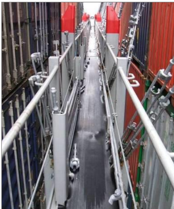
Figuur 11. Sjorstangen in het gangpad [2]
