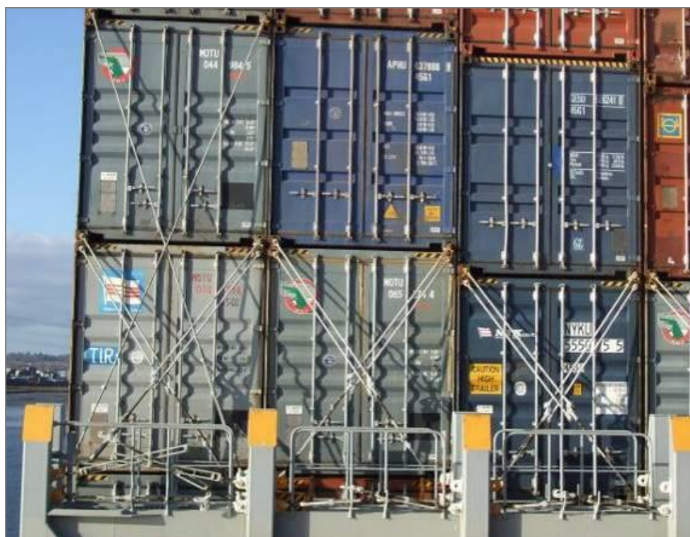
Figuur 10. Sijstangen plaatsing, de eerste rij aan de rand van het schip is driedubbel vastgezet. [2]
