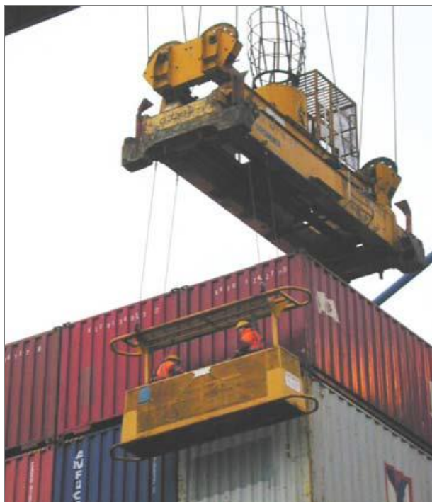
Figuur 15. Gondel voor plaatsen en verwijderen twistlocks [2]
