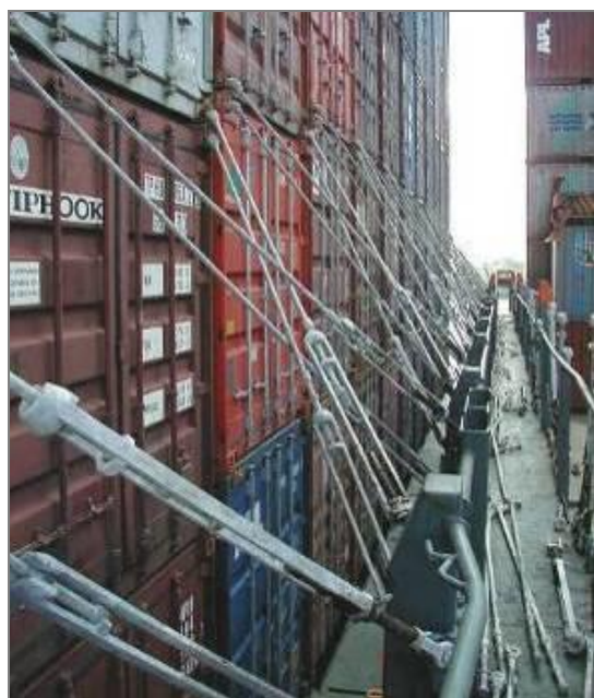
Figuur 13. Vastzetten van 40-voetscontainers in een 45-voets locatie [2]
