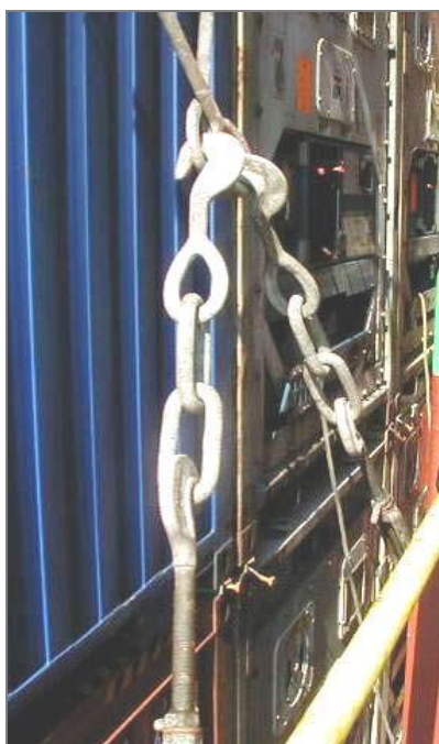
Figuur 12. Verlengde sjorstangen voor 'hi cube' containers (hoger dan de standaardcontainer) [2]
