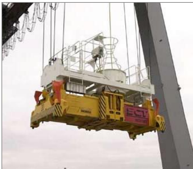
Figuur 17. Spreader voor het verplaatsen van containers [2]
