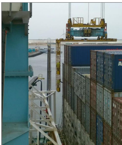
Figuur 3. Stuwadoors werken op hoogte in een gondel om twistlocks te openen en te verwijderen.
