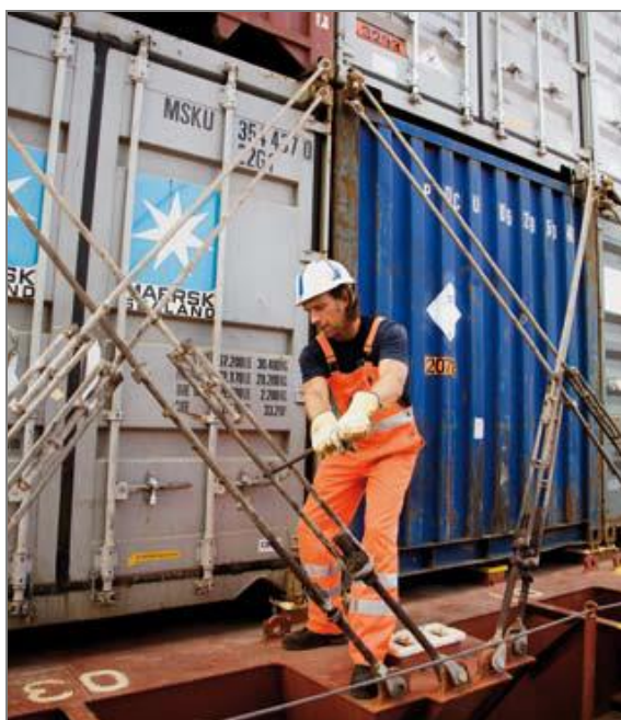
Figuur 4. Voorbeeld bevestigen sjoerstangen aan containers [4]
